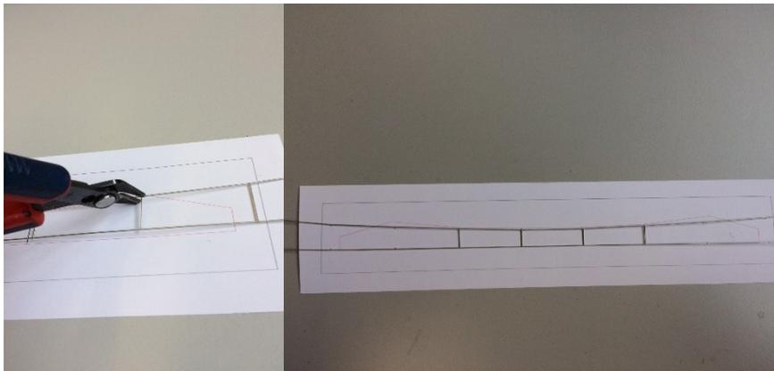
2. Den Fahrdrabt auf den Biegeplan auflegen und entlang der gezeichneten Kanten biegen.
