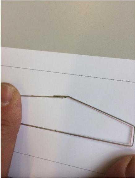
4. Den Fahrdraht in die Bügel einfädeln und die Bügel für den Fahrdraht auf der Schiebebühne mittels Sekundenkleber montieren (es ist wichtig, die Bügel erst mit Kleber zu fixieren, wenn der Fahrdraht eingefädelt ist).
